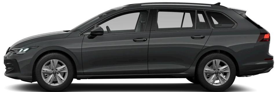
**Golf Variant Life 2,0 l TDI SCR 110 kW (150 PS) 7-Gang-Doppelkupplungsgetriebe DSG**
